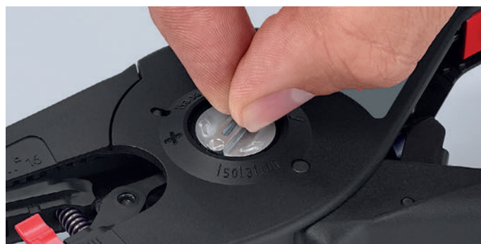
Vyžadují-li to zvláštní okolnosti, například tvrdý nebo měkký izolační materiál, je možné nastavovacím kolečkem s hmatatelnými polohami (s aretací) provést optimální jemné nastavení
