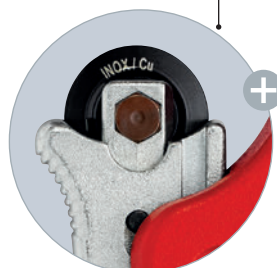
Řezné kolečko s jehlovými ložisky a odpružením je z vysoce kvalitní oceli pro kuličková ložiska a snadno se vyměňuje
