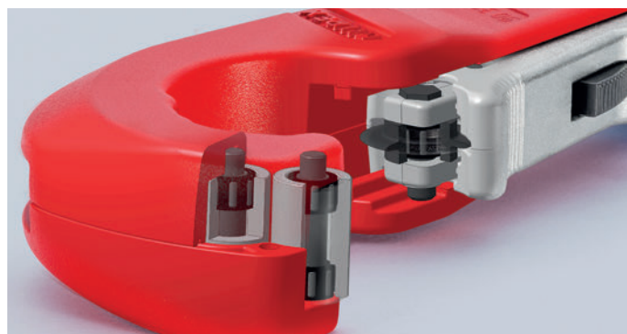
Díky vysoce kvalitním jehlovým ložiskům se řezné kolečko i čtyři vodicí válečky při řezání otáčejí takřka bez obtěžujícího tření – zvláště snadné řezání trubek z nerezové oceli
